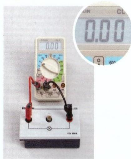
Fig.1 : Tension aux bornes d'une lampe.
