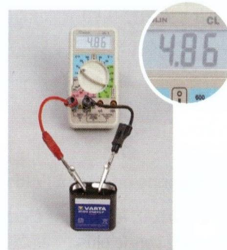
Fig. 2 : Tension aux bornes d'une pile.
