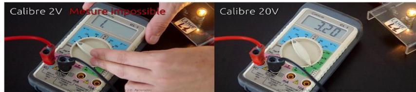
Le calibre de 2V est trop petit et ne permet pas de faire la mesure. On obtient un message d'erreur.
