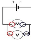
Le voltmètre se branche en dérivation aux bornes du dipôle. L'entrée V reliée à la borne proche du +, la sortie com reliée à la borne proche du - de la pile
