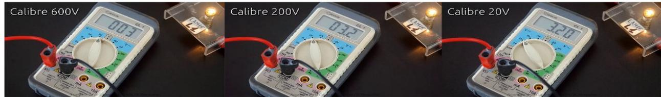
On commence la mesure par le plus grand calibre « 600 V ». On peut lire une mesure de  $U = 3 \text{ V}$ .
