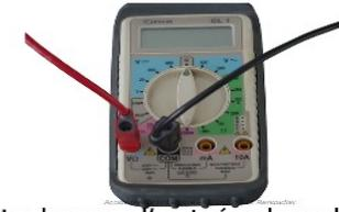
La borne d'entrée du voltmètre est le « V » et la borne de sortie est le « COM ».
