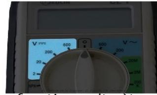
La fonction voltmètre est visible sur l'appareil avec le symbole « V=∞ ».
