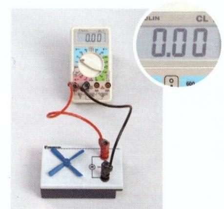
Fig. 3 : Tension aux bornes d'un moteur.
