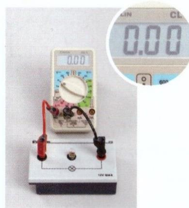
Fig.1 : Tension aux bornes d'une lampe.
