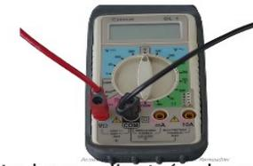
La borne d'entrée du voltmètre est le « V » et la borne de sortie est le « COM ».
