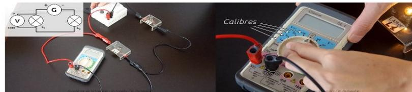
Pour l'exemple on mesure la tension aux bornes de la lampe L1. Voici le schéma et le montage.
